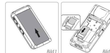
**Bild 1:** Akku-Deckel entfernen
