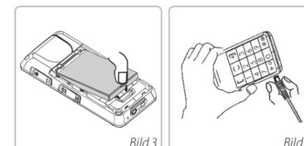
**Bild 3:** Akku einlegen, Deckel in die Verankerung schieben
